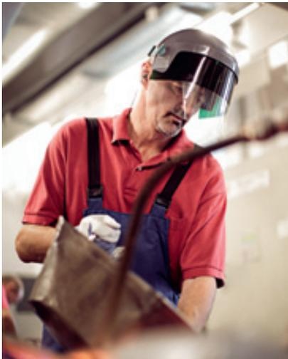
Vom Schmelztiegel gelangt das flüssige Gold in den doppelt so großen Warmhaltetiegel. Von dort wird der Strang kontinuierlich abgezogen, gewalzt und zu einem 40 Meter langen Band aufgerollt. Erst wenn die Analyse der Goldprobe die vorgesehene Reinheit – beim Wiener Philharmoniker sind es exakt 999,9 Promille – bestätigt, darf das gewalzte Gold zu sogenannten Rondens, so heißen die Münzrohlinge, weiterverarbeitet werden.
